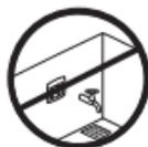
Der Thermostat darf nicht in feuchten Räumen angebracht werden. Platzieren Sie ihn in diesem Fall in einem angrenzenden Raum. Platzieren Sie den Thermostaten stets gemäß den lokalen IP-Schutzartvorschriften.
