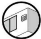
Platzieren Sie den Bodenfühler nicht in der Nähe von Türöffnungen oder an Stellen, an denen sich Sonnenlicht oder andere Wärmequellen im Fußbodenbelag befinden.
