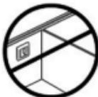
Platzieren Sie den Thermostat nicht an der Innenseite einer schlecht isolierten Außenwand.
