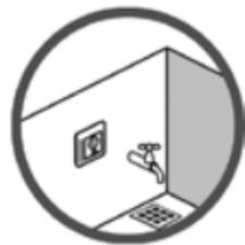
In Feuchträumen sollte der Thermostat an einer ebenen Fläche, unter Beachtung der örtlichen Bauvorschriften, installiert werden.
