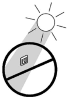
Nicht an einer Wand, wo der Thermostat direkt dem Sonnenlicht ausgesetzt ist.
