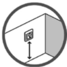
Die Installationshöhe liegt üblicherweise zwischen 80-150 cm, da beim Devireg™ 531 und 532 ein Raumfühler verwendet wird.
